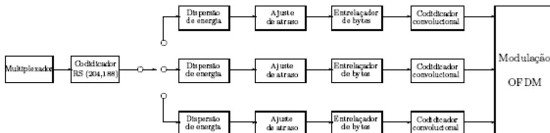
Figura 50 – Diagrama em blocos da codificação de canal [22].
