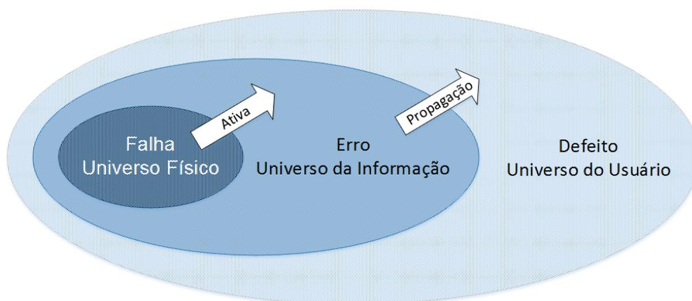
Figura 4.2: Relação entre Falha, Erro e Defeito
