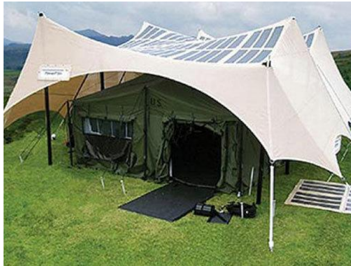
Figura 2: Tenda do exército norte-americano, equipado com células fotovoltaicas
