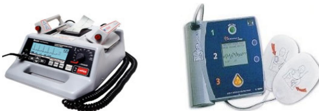
**Figura 10: Modelos de desfibrilador convencional e automático**
