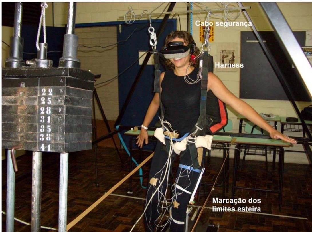
**Figura 52: Dispositivos de segurança: Cabos, *harness* e marcações.**
