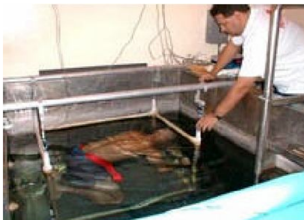
Figura 13 - Pesagem hidrostática de um voluntário (usando sistema de plataforma de força) Fonte: Heyward 97 .
