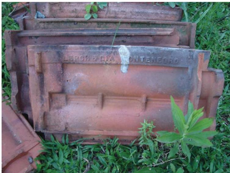
Figura 127: Exemplos de telhas do tipo francesa, fabricadas na antiga Olaria Lerch & Cia<sup>180</sup>, em Montenegro
