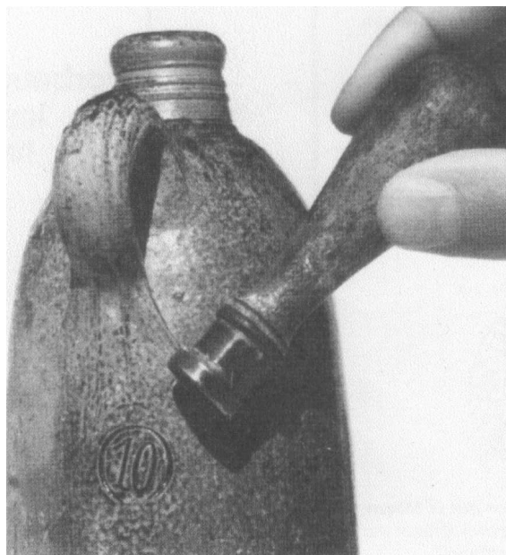
Figura 02: representação da aplicação de inscrições na superfície de garrafas de grés. Fonte: Nienhaus (1986).
