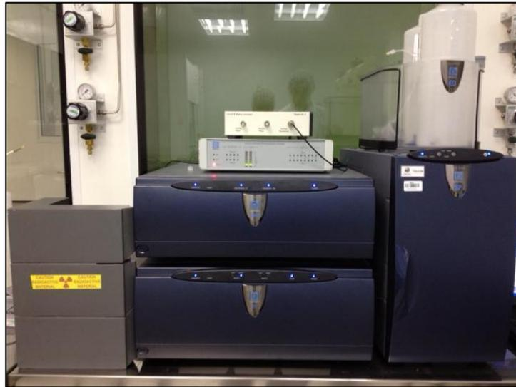
Figura 13. Cromatógrafo Líquido de Alta Eficiência, Dionex (InsCer, 2013).
