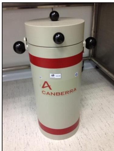
Figura 14. Espectrômetro de raios gama (InsCer, 2013).
