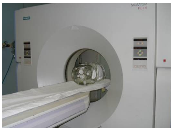
Figura 20: Modelo físico posicionado em equipamento de CT (Siemens) para aquisição de imagem para gerar mapa de correção de atenuação não uniforme.
