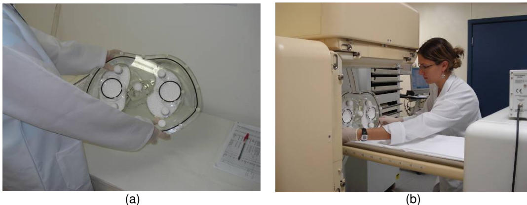
Figura 19: (a) Preparo do modelo físico antropomórfico, conforme as concentrações de atividade de referência; (b) Posicionamento do modelo na câmara Philips FORTE para protocolos de aquisição com ^{99m}\text{Tc} -Sestamibi.
