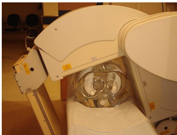
Figura 21: Modelo físico posicionado em equipamento SPECT com fonte de transmissão para mapa de atenuação não uniforme.
