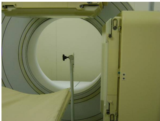
Figura 25: Aquisição de fonte “pontual” posicionada a diferentes distâncias do colimador para o teste de sensibilidade do sistema com a variação da distância fonte-detector.
