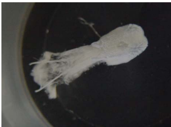
Figura 11: Espécime corroído submerso em água destilada
