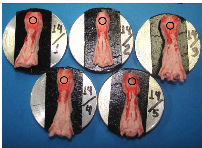
Figura 13: Colagem dos espécimes corroídos sobre as plataformas de alumínio, o círculo representa a área da ferida cirúrgica a ser analisada pela MEV
