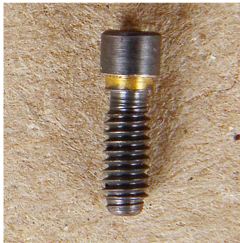
Figura 05 - Parafuso de titânio com tratamento de superfície com engate quadrado (Conexão ® , Sistemas de Prótese Ltda., São Paulo, Brasil)
