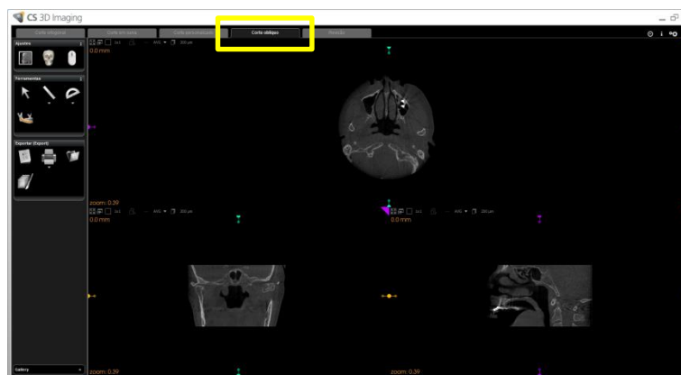
Figura 15 - Visualização da aba “Corte Oblíquo”, em destaque, com os planos ortogonais axial, coronal e sagital.
