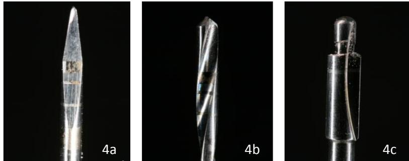
Figuras 4a,4b,4c – Sequencia de brocas utilizadas na perfuração. Broca Lança (4a), Broca Helicoidal de 2 mm (4b) e broca piloto 2/3(4c). Fonte: Dados da pesquisa.
