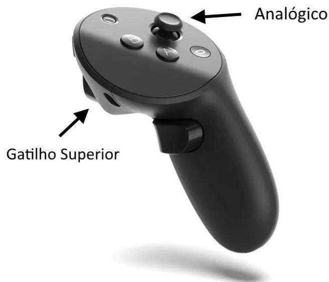
Figura 4: Botões utilizados do controle do Meta Quest Pro.
