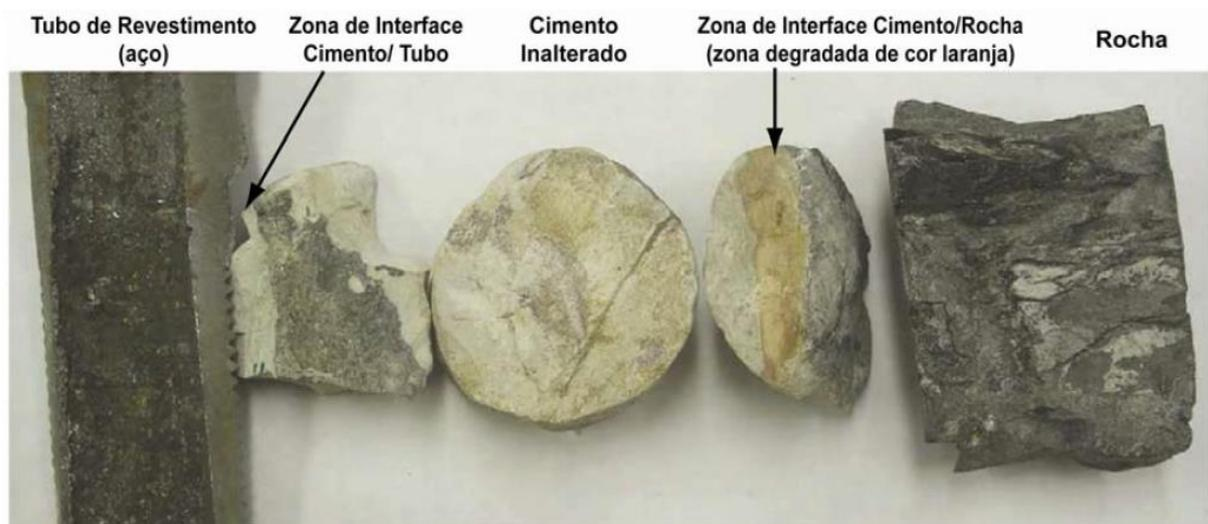
Figura 3.22. Degradação de Testemunhos de aço, cimento e rocha do campo de SACROC no Texas - EUA. Adaptado de Carey *et al.* (2007).
