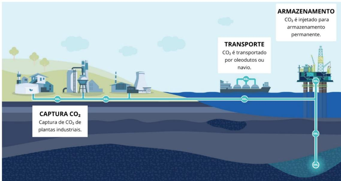
Figura 3.18. Etapas do processo de captura e armazenamento de carbono. Adaptado de Global CCS Institute (2022).
