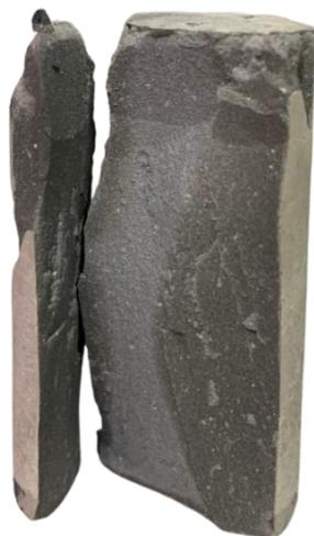
Figura 5.24. Amostra de 0,5% n-Al<sub>2</sub>O<sub>3</sub> após reação com CO<sub>2</sub>, destacando o mecanismo de fratura observado no ensaio de resistência à compressão.
