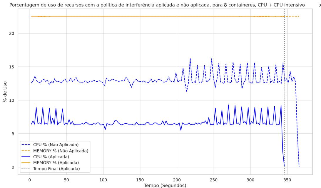
Figura 6.8 – Uso de recursos, carga de trabalho "CPU + CPU", oito contêineres.
