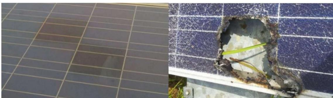
Figura 3.18. Dois módulos FVs com pontos quentes, sendo que no segundo a célula solar foi destruída (Kim *et al.*, 2021).
