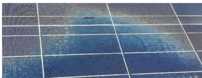
Figura 3.14. Módulo fotovoltaico com muitas bolhas (Kim *et al.*, 2021).
