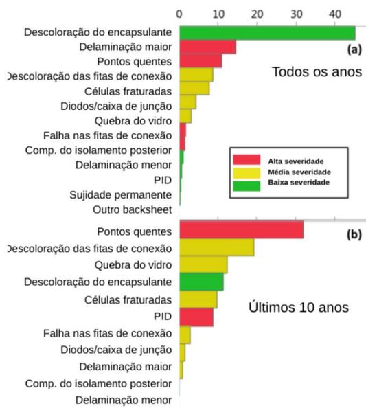
Figura 3.24. Modos de degradação mais significativos para (a) todos os anos e (b) sistemas instalados nos últimos 10 anos. As colunas são codificadas por cores de acordo com a gravidade. Adaptado (Jordan *et al.*, 2017).
