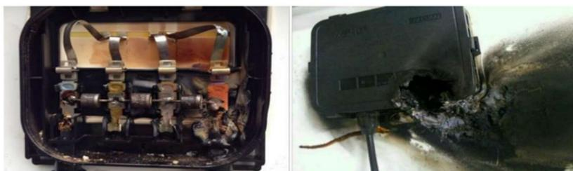
Figura 3.21. Caixas de junção deterioradas por defeitos no funcionamento (Kim *et al.*, 2021).
