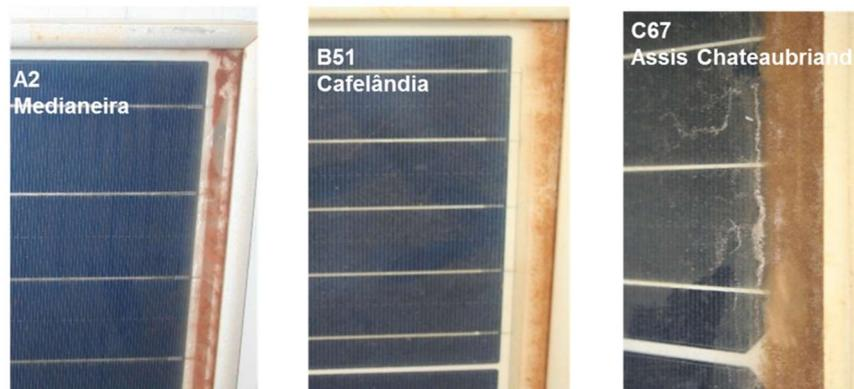
Figura 6.31. Sujidade depositada nos módulos FVs de teste instalados nas propriedades rurais em Medianeira (módulos de 270 Wp), Cafelândia (módulos de 325 Wp) e Assis Chateaubriand (módulos de 340 Wp), após o primeiro ano de operação.
