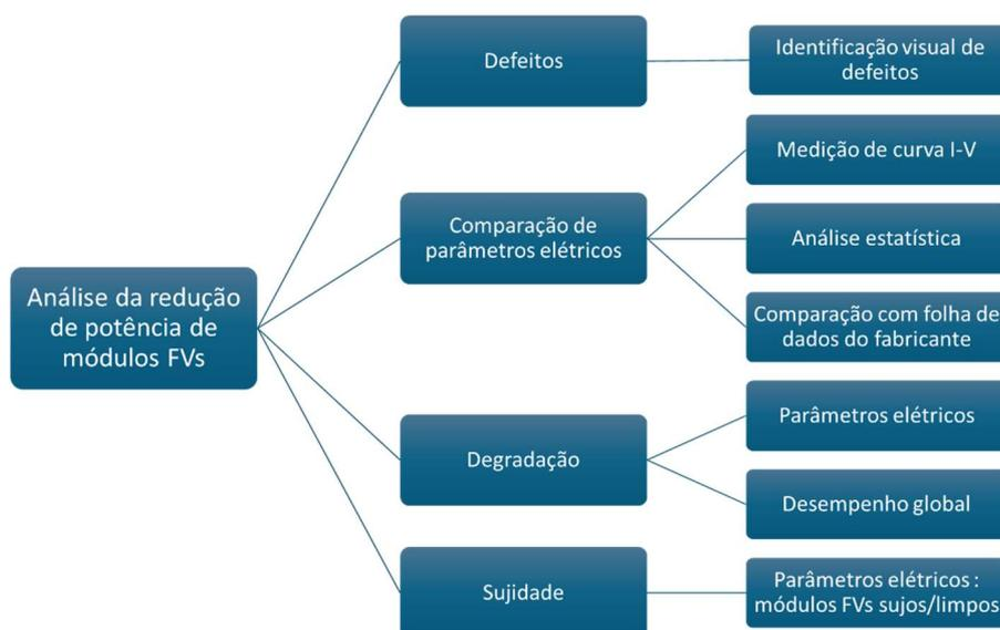
Figura 5.1. Diagrama da metodologia adotada para a análise da redução de potência dos módulos fotovoltaicos.
