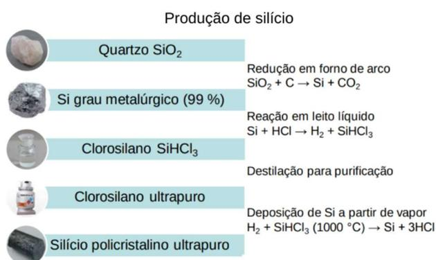
Figura 2.1. Esquema representativo resumido das etapas da produção de silício, da extração até a formação de silício ultrapuro (MOEHLECKE; ZANESCO, 2021).
