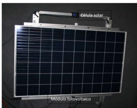
Figura 5.4. Módulo fotovoltaico de 270 Wp colocado na estrutura de fixação para medição da curva característica corrente elétrica em função da tensão elétrica (I-V). Na parte acima do módulo, há uma célula solar padrão para medir a irradiância incidente.
