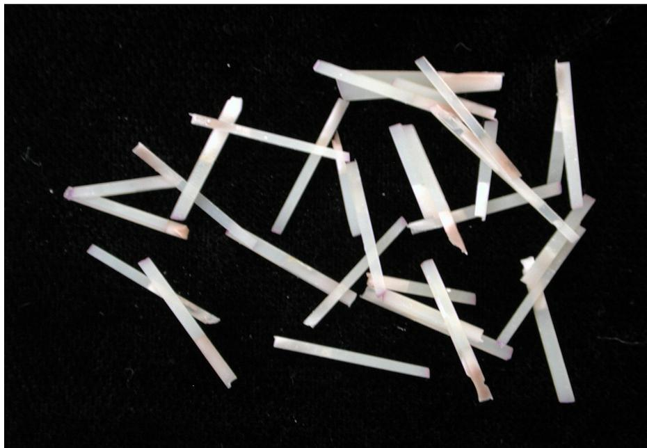
Figura 4: Corpos-de-prova em forma de palitos
