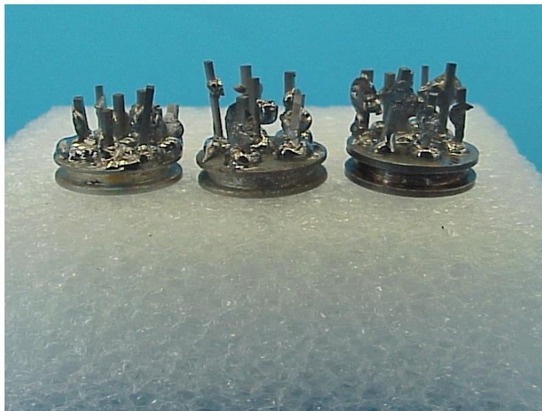
Figura 6: Porções fixadas em *stubs* para observação em MEV
