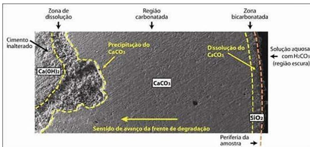
Figura 3.22 - Alterações microestruturais na pasta de cimento Classe G após reações com \text{CO}_2 . Fonte: Dalla Vecchia (2009).
