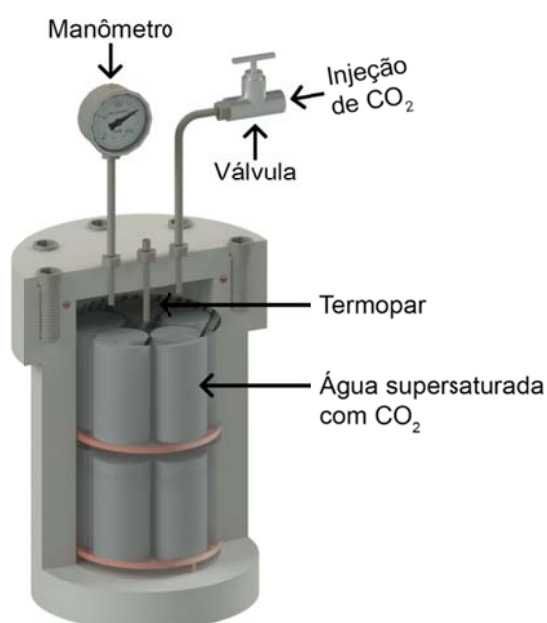
Figura 4.13- Ilustração dos corpos de prova de pasta de cimento distribuídos no vaso de pressão para os
