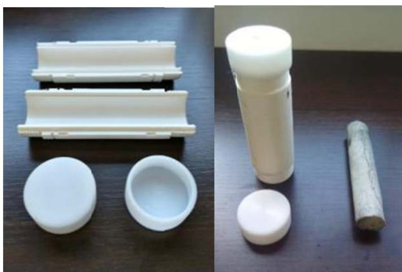
a) Molde em poliestireno feito em impressora 3D
