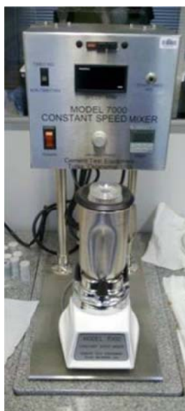
Figura 4.10 - Misturador utilizado para a elaboração das pastas de cimento. Fonte: Autor
