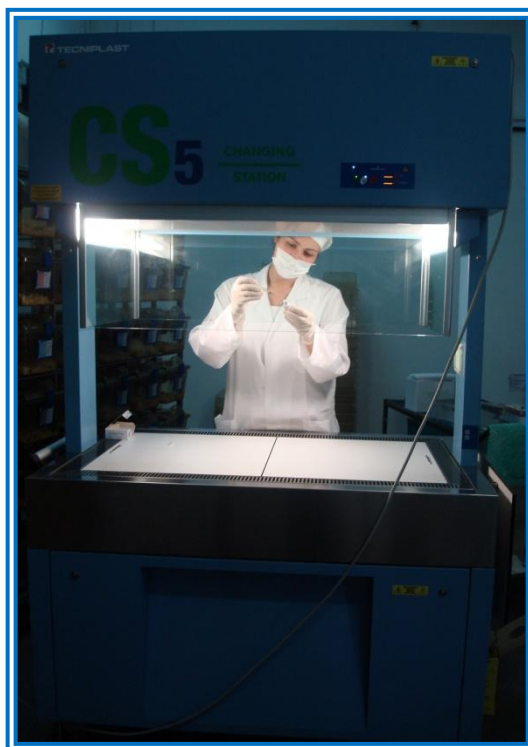
Figura 09 – Cabine de Troca (tecniplast CS5): o ar ambiente é introduzido num módulo de envio, previamente filtrado, antes de ser distribuído na área de trabalho com fluxo laminar unidirecional.
