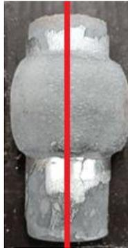
Figura 4.17 - Ponto de corte da peça forjada para análises microestruturais, macroestruturais e durezas [Elaborado pelo Autor].
