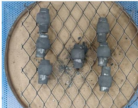
Figura 5.11 - Corpos de prova com taxa de resfriamento de  $0,8 \text{ }^\circ\text{C/s}$  [Elaborado pelo Autor].
