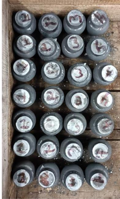
Figura 5.17 - Corpos de prova forjados [Elaborado pelo Autor].
