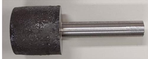
Figura 5.19 - Peça obtida na primeira etapa de usinagem [Elaborado pelo autor].
