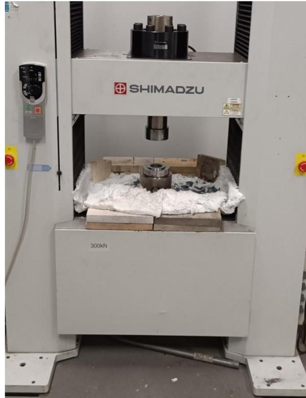
Figura 4.9 - Prensa com matrizes fixadas na máquina [Elaborado pelo Autor].
