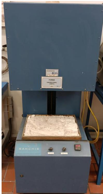
Figura 4.7 - Forno Sanchis para aquecimento dos corpos de prova [Elaborado pelo Autor]
