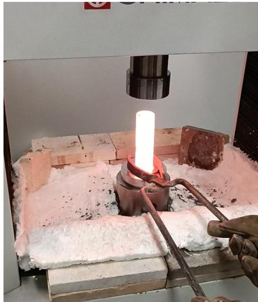
Figura 5.10 - Posicionamento do corpo de prova para conformação [Elaborado pelo Autor].
