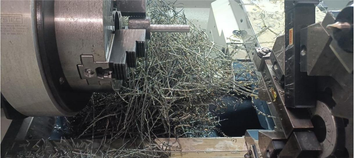
Figura 5.31 - Acúmulo de cavaco durante usinagem de uma amostra [Elaborado pelo Autor].
