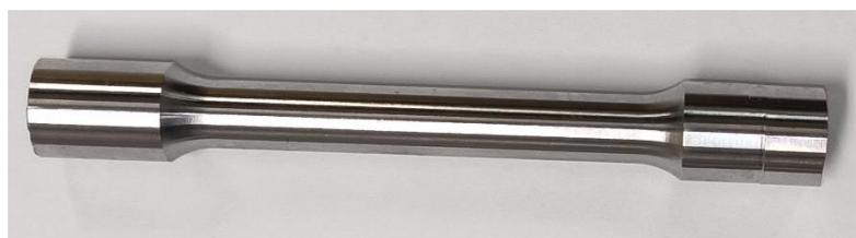
Figura 5.35 - Corpo de prova para ensaio de tração [Elaborado pelo Autor].
