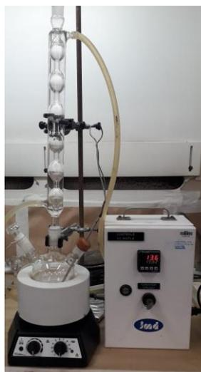
Figura 4.3. Imagem digital do sistema utilizado nas reações de glicólise de PET pós-consumo com diferentes cores.
