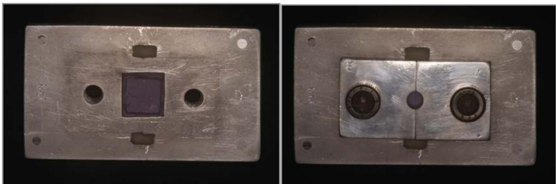
**Figura 2:** Matriz de alumínio utilizada para padronizar aplicação cerâmica.
