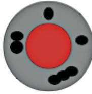
Fig. 1: Os objectos nunca devem ser colocados no círculo interior do tabuleiro de cocção (área vermelha).
