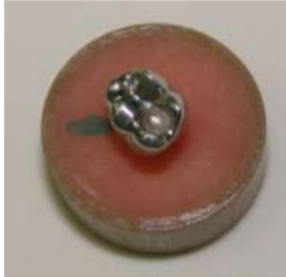
Figura 8: Coroa metálica instalada sobre o pilar protético do corpo de prova
