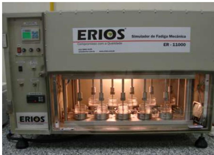
Figura 9: Simulador de fadiga mecânica
