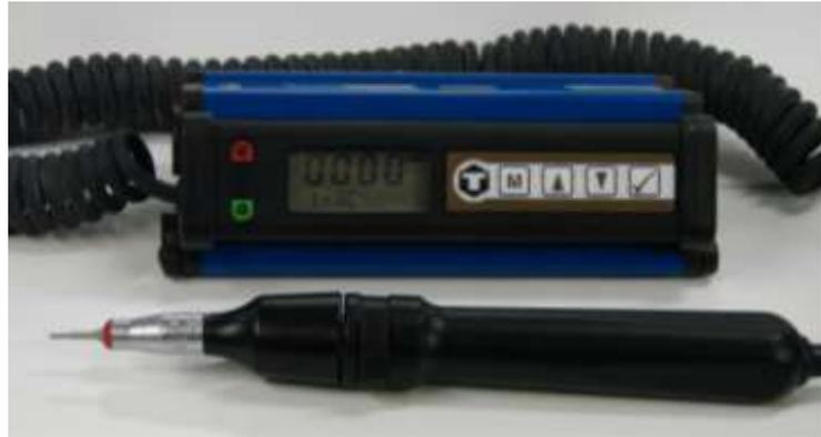
Figura 10: Torquímetro digital com chave hexagonal acoplada
