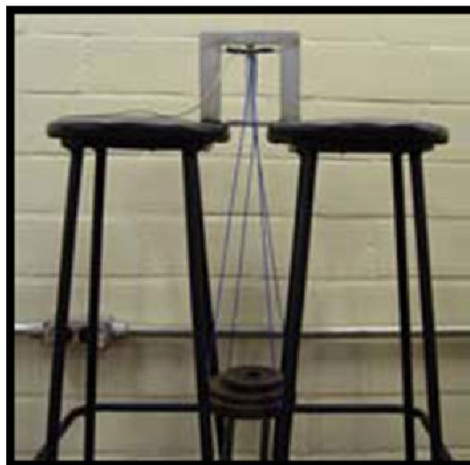
Figura 07 – Calibração da célula de pré-carga
