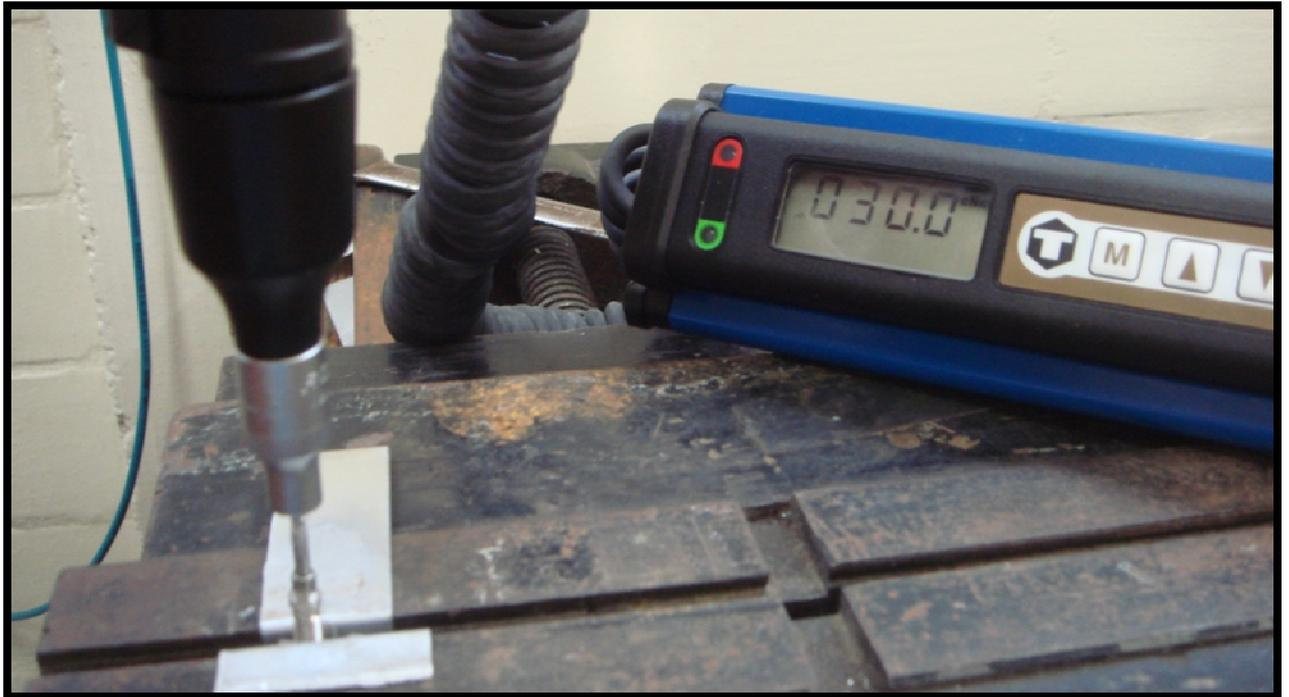
Figura 12- Torquímetro digital + Chave quadrada 1,27mm com seu respectivo adaptador
