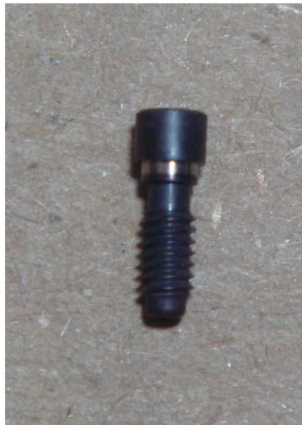
Figura 04 – Parafuso de Titânio com tratamento de superfície
