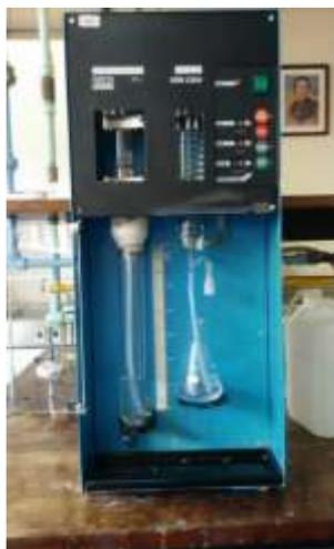
Figura 4.5. Destilador Kjeldahl.
