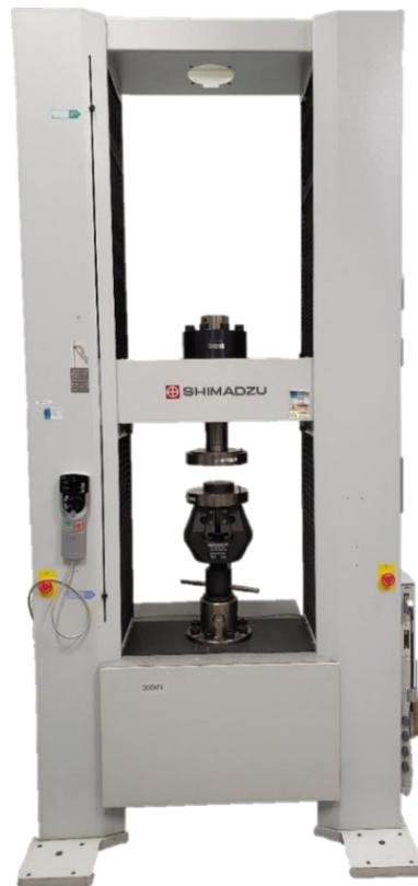
Figura 4.4. Fotografia da máquina universal de ensaios mecânicos da marca Shimadzu, modelo AG-IC 300KN.
