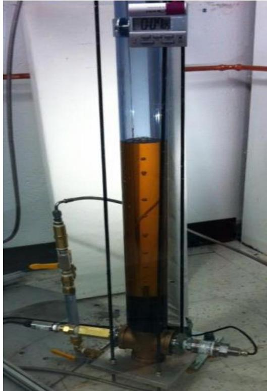
Figura 3.12. Ensaio de pressão hidrostática da resina líquida para avaliar a possibilidade de formação de caminhos preferenciais causados por migração de gases com pressão superior a pressão resultante da coluna hidrostática da resina. Fonte: Urdaneta *et al.* (2014).
