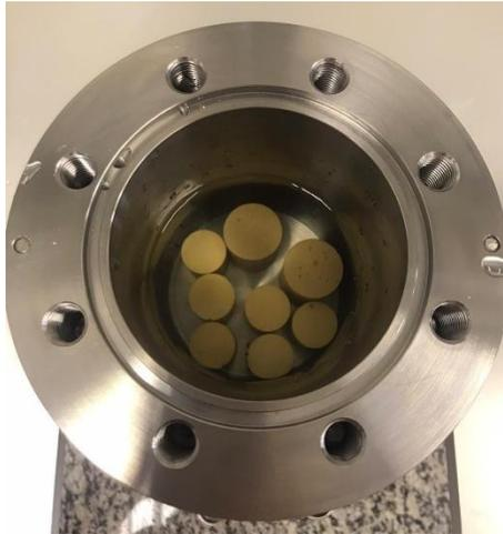
Figura 4.3. Corpos de prova submersos em água distribuídos no interior do reator.
