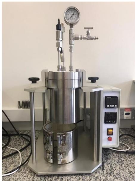
Figura 4.2. Reator utilizado para o ensaio de degradação por CO<sub>2</sub> em condições supercríticas.
