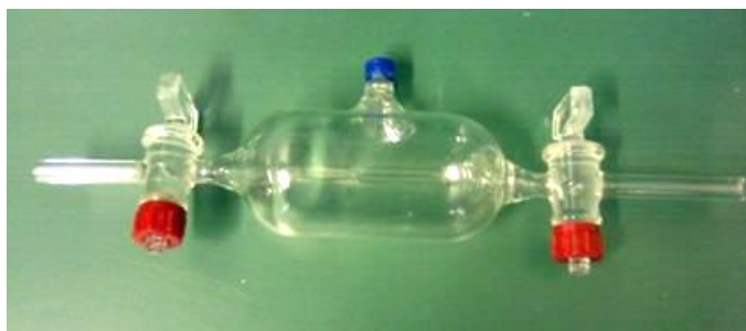
Figura 4.15. Cápsula de gás de 100 mL, utilizada na diluição dos gases.
