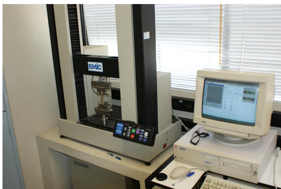
Figura 9: amostra montada na máquina de ensaio para o teste biomecânico de Pull-out.
