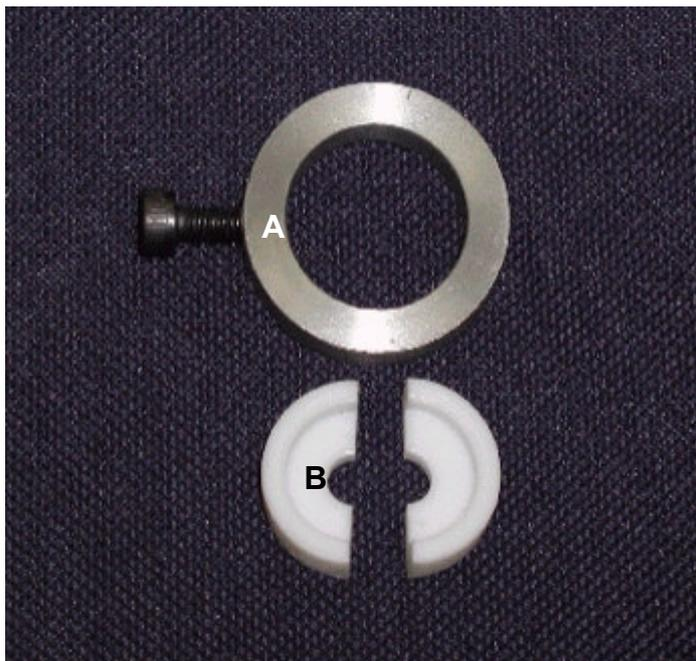
FIGURA 1 - Dispositivo para confecção das amostras para o teste de microdureza Knoop: (A) suporte metálico; (B) matriz bipartida de PTFE.
