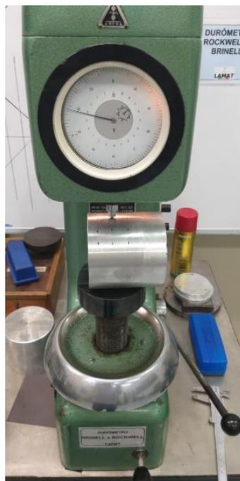
Figura 4.7: Durômetro Brinell – Laboratório de Materiais/EP/PUCRS.
