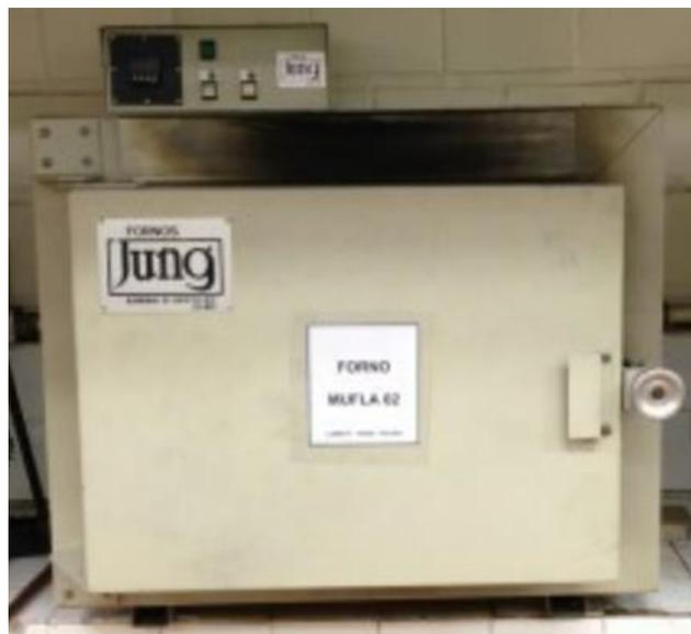
Figura 4.4: Forno tipo Mufla - Laboratório de Materiais/EP/PUCRS.
