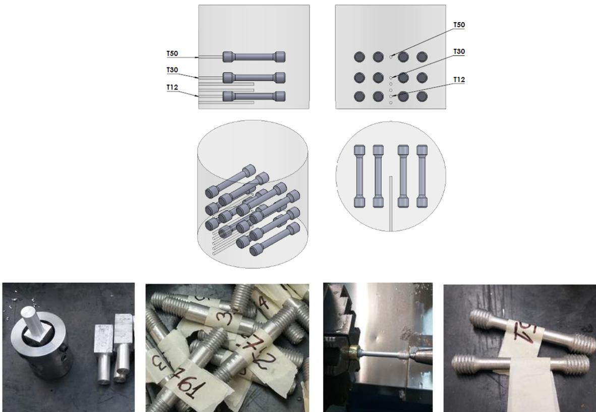
Figura 4.11: Obtenção dos corpos de prova para ensaio de tração. Fonte própria.
