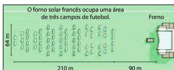
Figura 35: Esquema da posição dos espelhos no forno solar de Odeillo
