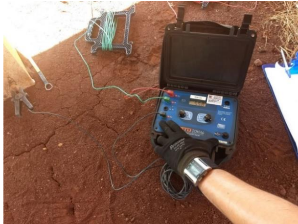
Figura 4.32. Medição resistência de aterramento haste “A”, a uma distância de 10 m.
