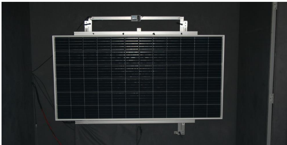
Figura 3.5. Módulo fotovoltaico de 325 Wp colocado na estrutura de fixação para medição da curva característica corrente elétrica em função da tensão elétrica (I-V). Na parte acima do módulo, há uma célula solar padrão para medir a irradiância incidente.
