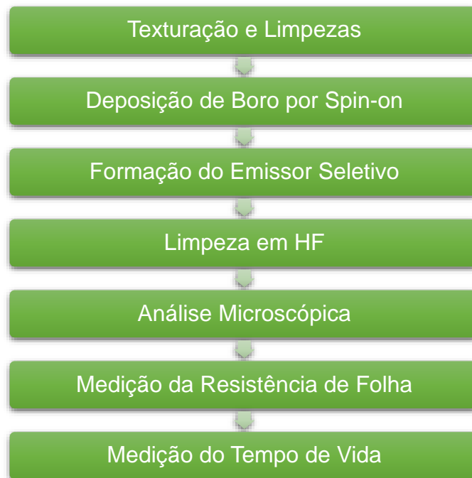
Figura 3.1: Processo teste para otimização dos parâmetros do laser.
