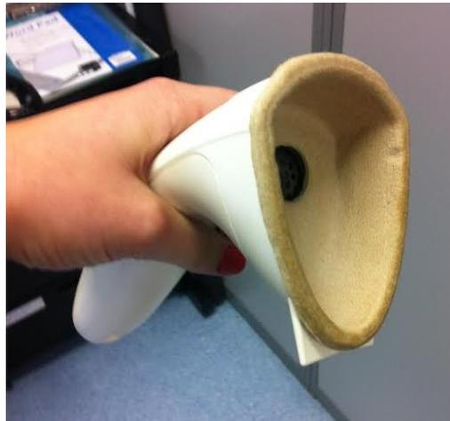
**Figura 2:** Local de inserção da orelha para realização do teste. Fonte: a autora.
