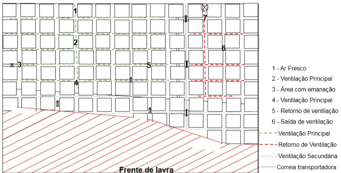
Figura 4.2. Representação dos pontos de coleta nas minas A, B e C.
