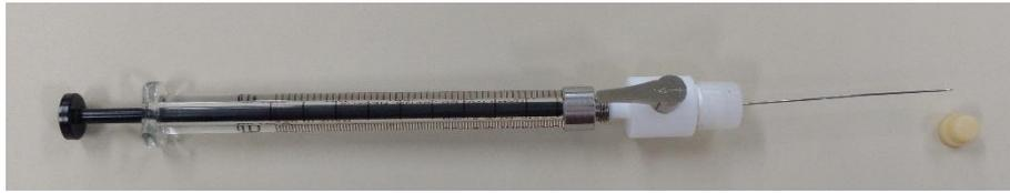
Figura 4.4. Seringa com válvula adaptada para análises dos Métodos 1 e 2.
