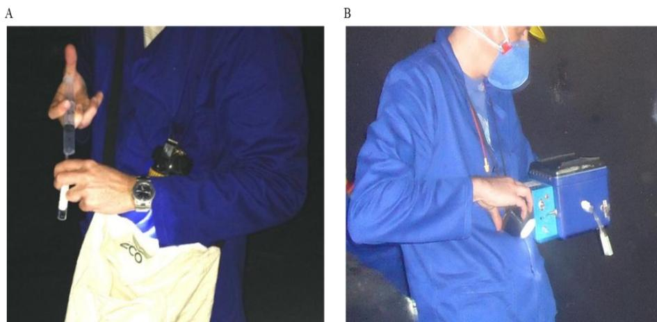
Figura 4.3. Procedimentos de Coleta de amostras gasosas em: a) Coleta nos frascos realizada na mina de carvão. b) Coleta nos sacos realizada na mina de carvão.
