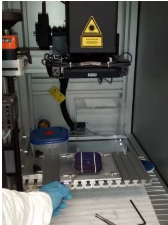
Figura 4.13. Célula solar cortada a laser no formato pseudo-quadrado.
