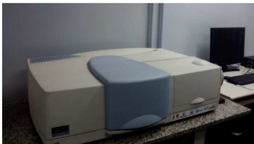
Figura 4.15. Espectrofotômetro utilizado para medir a refletância.
