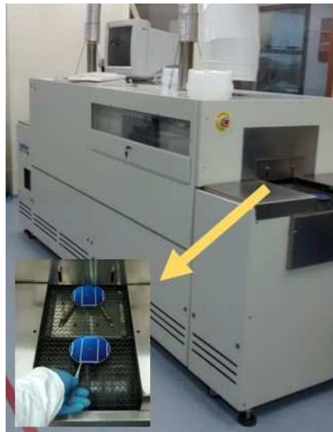
Figura 4.11. Forno de esteira utilizado para secagem e queima das pastas de serigrafia sobre as lâminas de silício, em detalhe, a saída das mesmas.
