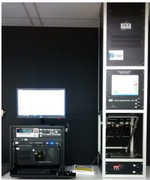
Figura 4.14. Simulador solar para medida de parâmetros elétricos.
