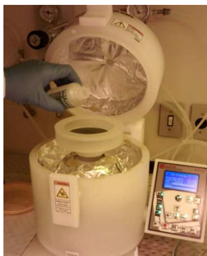
Figura 4.4. Spinner para deposição da solução líquida dopante.
