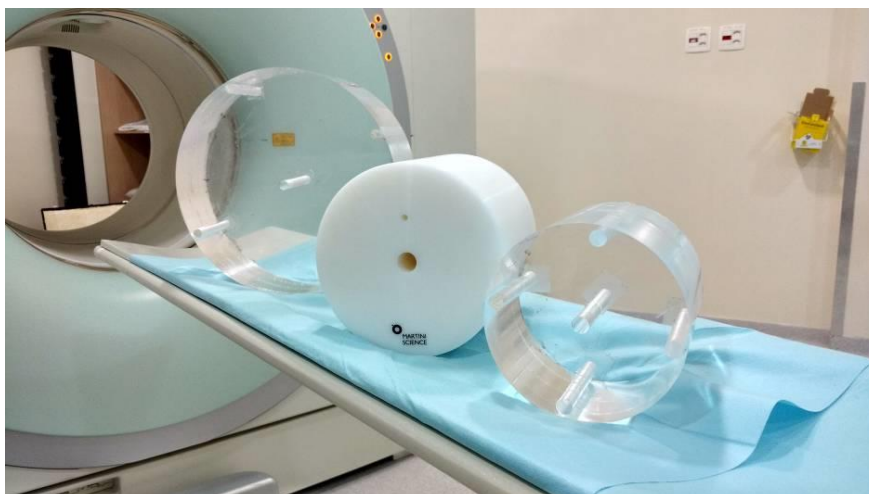
Figura 7. Fotografia dos três simuladores utilizados na aquisição de dados de PET/CT neste trabalho. Da esquerda para a direita: simulador de PMMA de 32 cm de diâmetro; simulador de Polietileno de 29 cm; simulador de PMMA de 16 cm.
