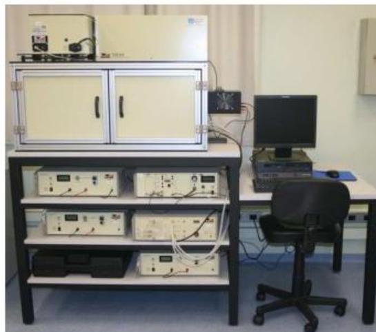
Figura 3.17. Equipamento utilizado para medição da resposta espectral e refletância.
