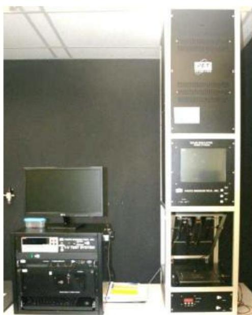
Figura.3.15. Simulador solar, utilizado na medição das células solares.
