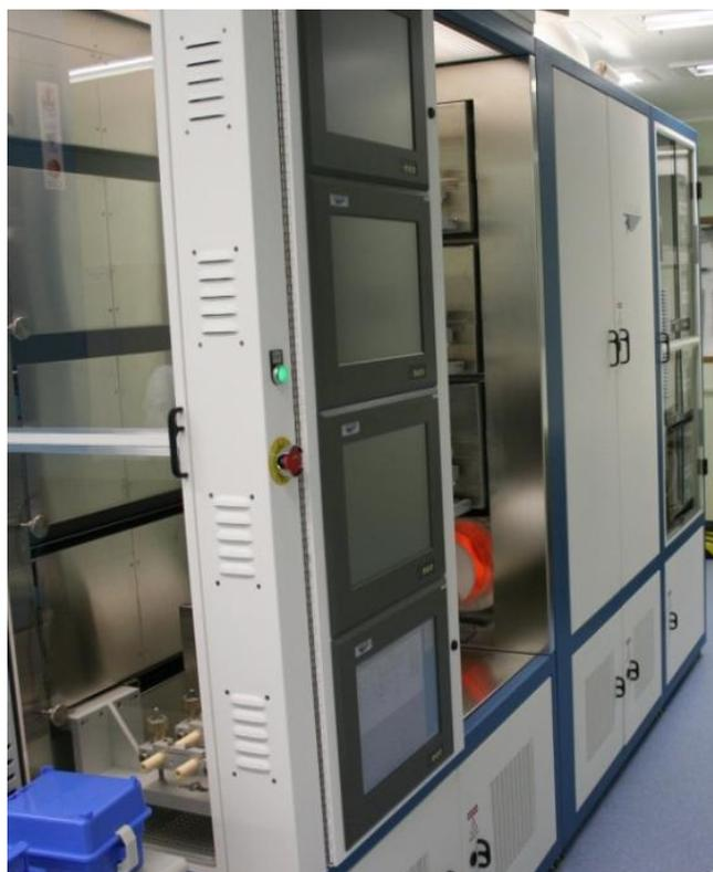
Figura 3.6. Forno utilizado para oxidação das superfícies das lâminas de silício.
