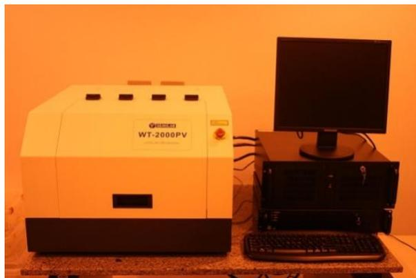
Figura 3.18. Equipamento WT-2000PV para a medição do comprimento de difusão dos portadores de carga minoritários com a técnica LBIC.
