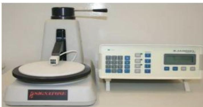
Figura 3.13. Equipamento denominado “quatro pontas” utilizado para medir a resistência de folha.
