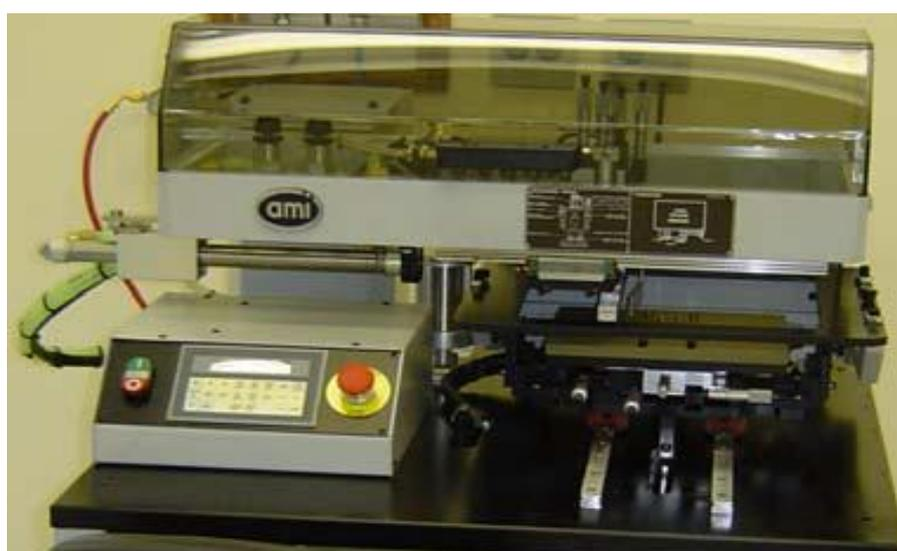
Figura 3.8. *Screen-printer* utilizado na deposição de malhas metálicas nas células solares.
