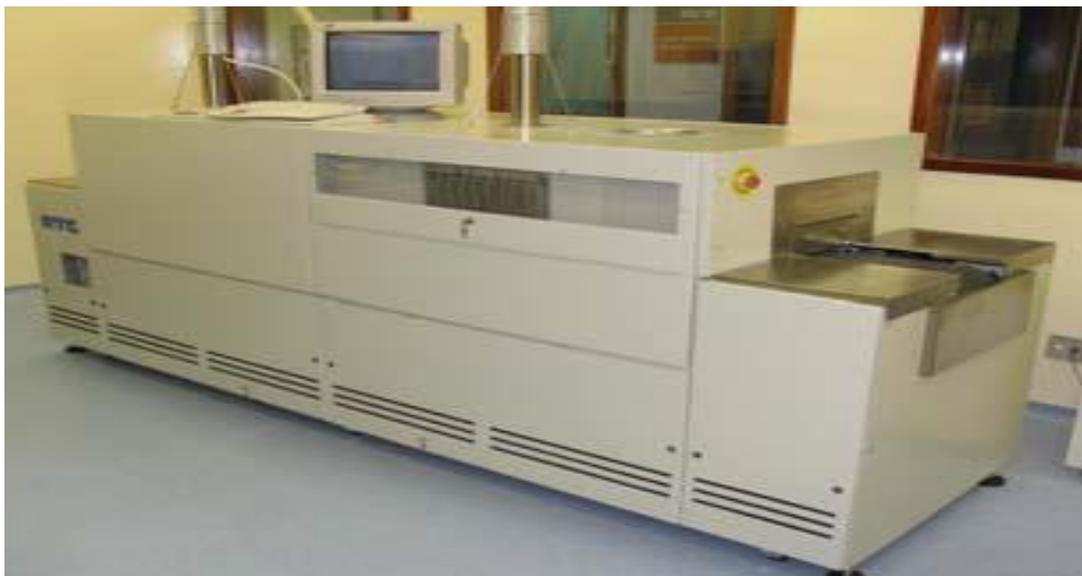
Figura 3.11. Forno de esteira, utilizado para a secagem e processo de queima/difusão das pastas metálicas.
