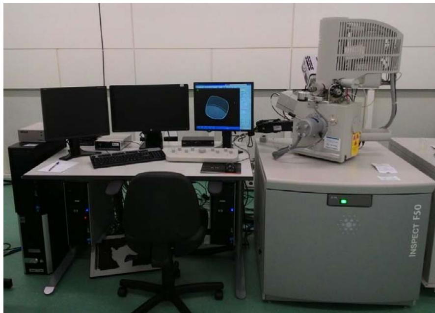
Figura 4.3.1. Microscópio Eletrônico de Varredura.
