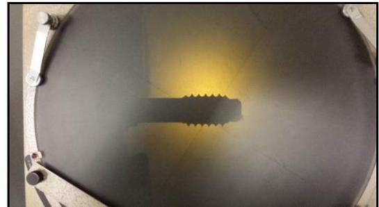
Figura 4.8. Perfil do parafuso observado no procedimento de diascopia.
