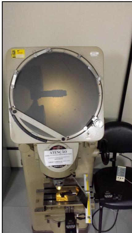
Figura 4.6. Projetor de perfil com imagem do parafuso em aumento de 20x.
