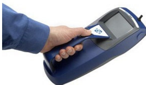
Figura 3 - Equipamento Dust Track ™ II aerossol Monitor modelo 8532.
