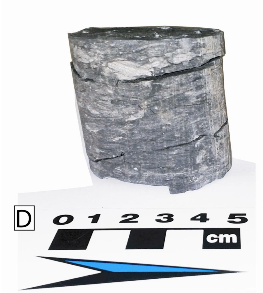
Figura 4.2 Amostras acondicionadas na litoteca da Copelmi Mineração LTDA. Amostra D- Folhelho da Formação Palermo 238,50m de profundidade.
