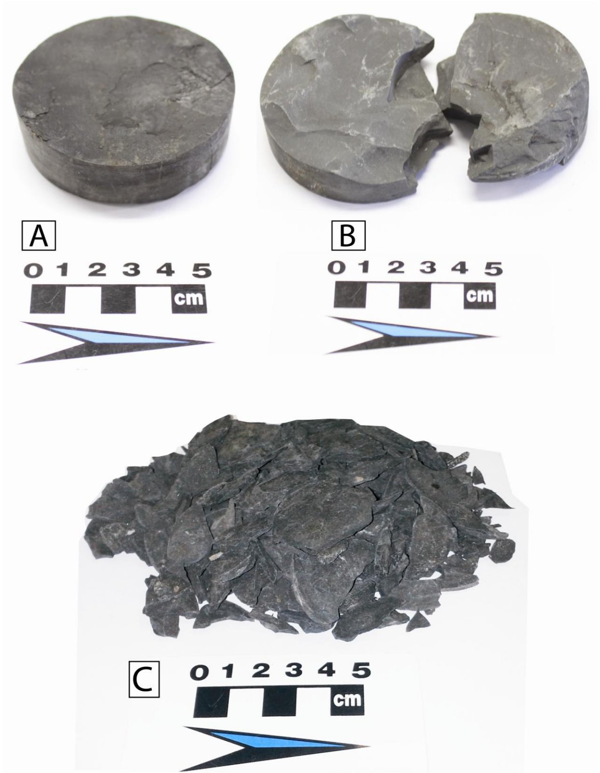
Figura 4.1 Amostras acondicionadas na litoteca do Centro de Excelência em Pesquisa e Inovação em Petróleo, Recursos Minerais e Armazenamento de Carbono (CEPAC). Amostra A- Folhelho da Formação Irati 95,30m de profundidade, amostra B- Folhelho da Formação Irati 107,50m de profundidade, amostra C- Folhelho da Formação Irati 218,45m de profundidade.
