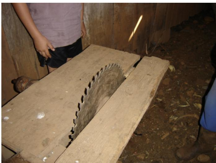
**Foto 5.** Instrumento de trabalho chamado de serra circular que ocasionou um acidente de trabalho.
