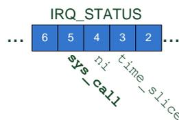
Figura 42 – Configuração do registrador `IRQ_STATUS` para o processador MB-Lite. Em destaque, o bit de interrupção `SYS_CALL` adicionado.
