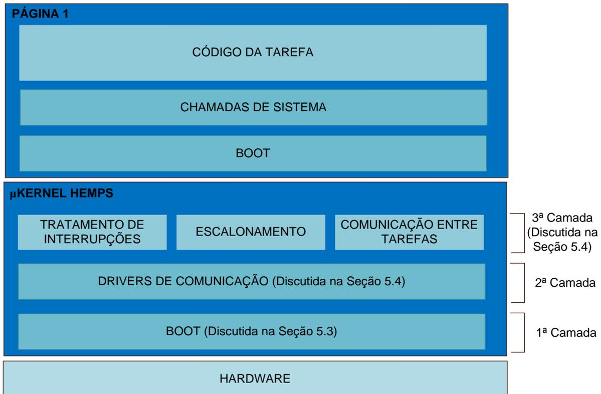
Figura 25 – Camadas de software da tarefa (Página 1) e do  $\mu$ kernel do Plasma-IP escravo do MPSoC HeMPS.
