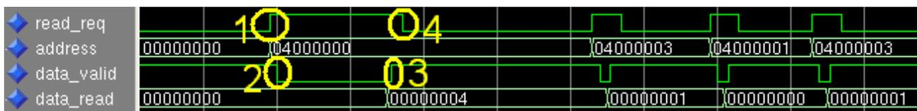
Figura 21 – Protocolo de quatro fases na interface entre o Plasma-IP mestre e o Main Control.
