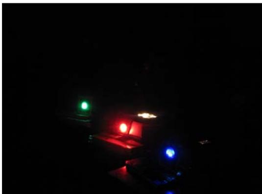
Fotografia 5 – Diferentes cores de luz obtidas com filtros de celofane.
