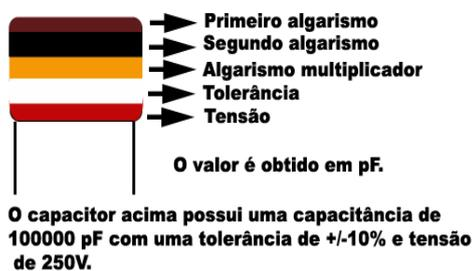
Figura 28 – Capacitor com o código das cores.
