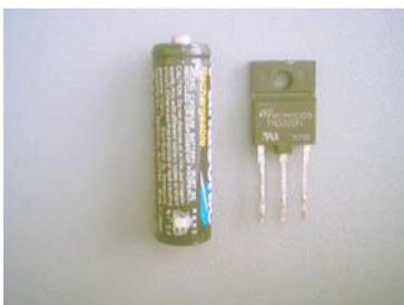
Figura 41 - Transistor moderno de alta potência.
