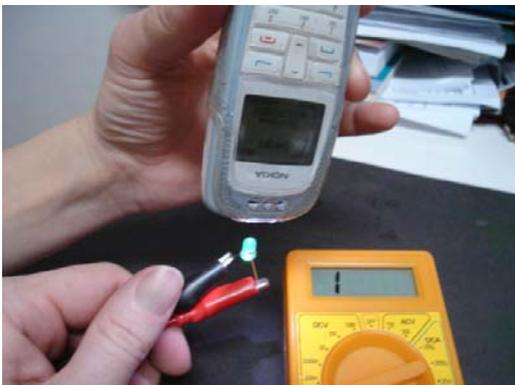
Fotografia 30 – LED conectado de forma invertida.
