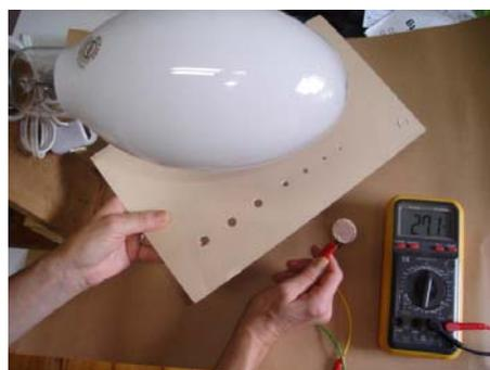
Fotografia 25 – Componentes para medição da resistência do LDR.
