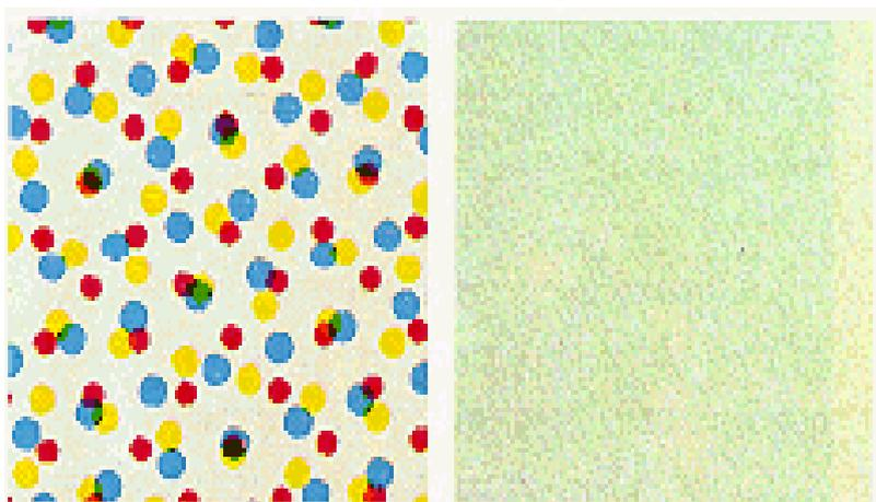
Figura 12 - Pontos de tinta depositadas por impressoras, a jato, coloridas, formando diferentes tonalidades de colorido.
