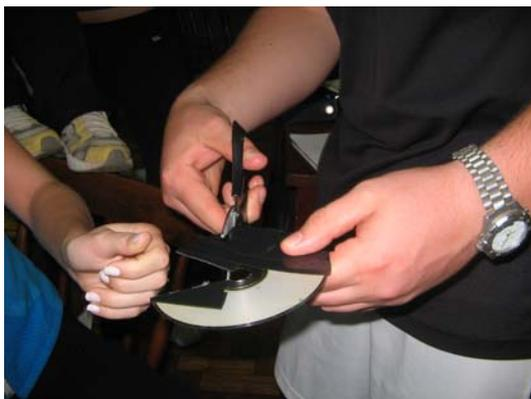
Fotografia 4 - Obtenção da rede de difração usando um disco compacto (CD).
