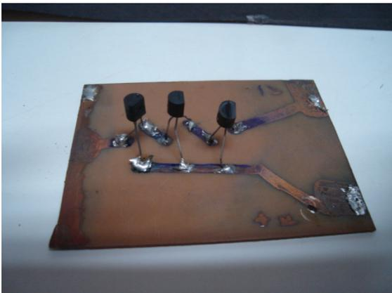
Fotografia 7 – Amplificador de transistores em cascata.
