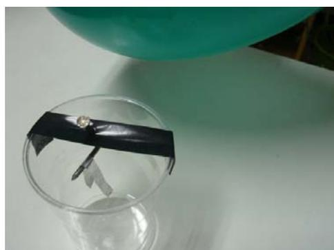
Fotografia 11 – Eletroscópio de folhas sofrendo indução.
