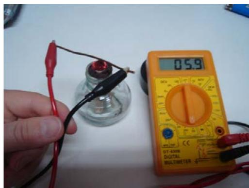
Fotografia 23 – Resistência do cobre aquecido.
