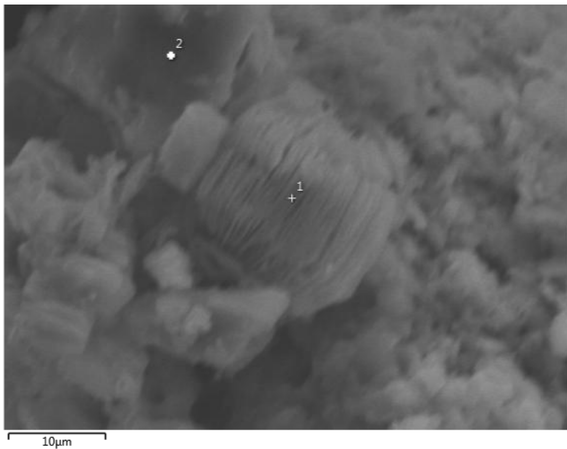
Figura 5.26. Imagem de grãos de quartzo (espectro 2) e aglomerados de caulinita (espectro 1) da amostra do experimento 2 no MEV (MAG 2400x, SE).
