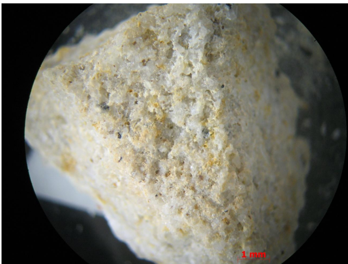
Figura 5.11. Imagem da amostra de rocha arenito, FP-10-30 pós-experimento com água milli-Q obtida através do MLB.
