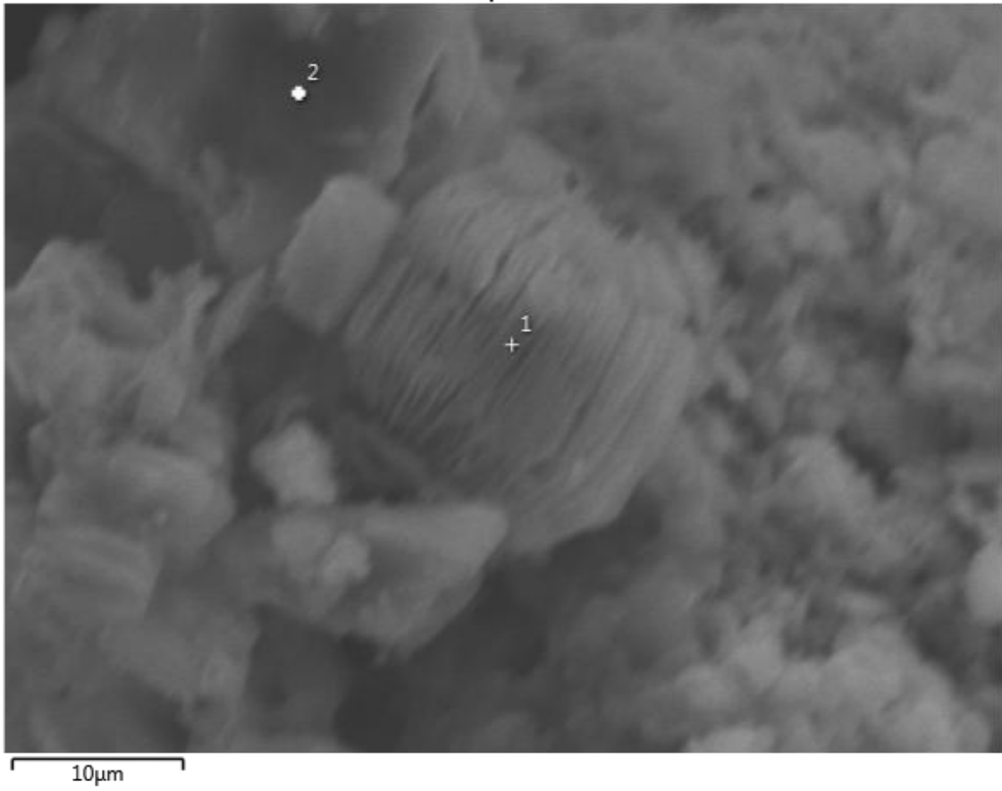
Figura A.6. Imagem de grãos de quartzo (espectro 2) e aglomerados de caulinita (espectro 1) da amostra do experimento 2 no MEV (MAG 2400x, SE).
