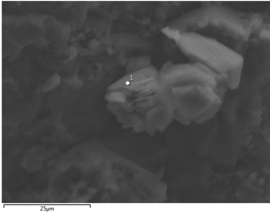
Figura A.4. Imagem de Imagem de cristais aglomerados de caulinita da amostra do experimento 1 no MEV (MAG 3000x, SE).
