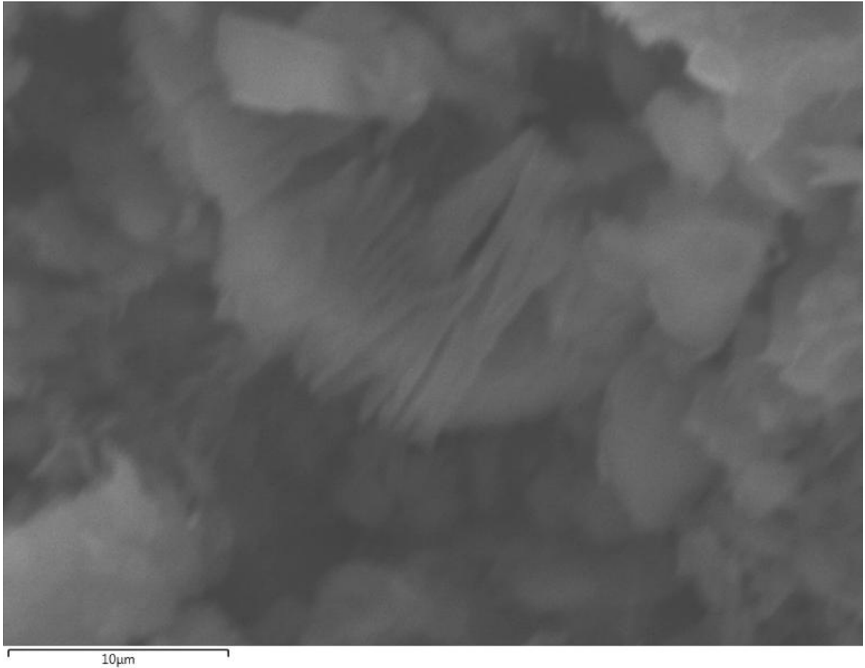
Figura 5.8. Imagem de cristais de caulinita da amostra inicial no MEV (MAG 6000x, SE).
