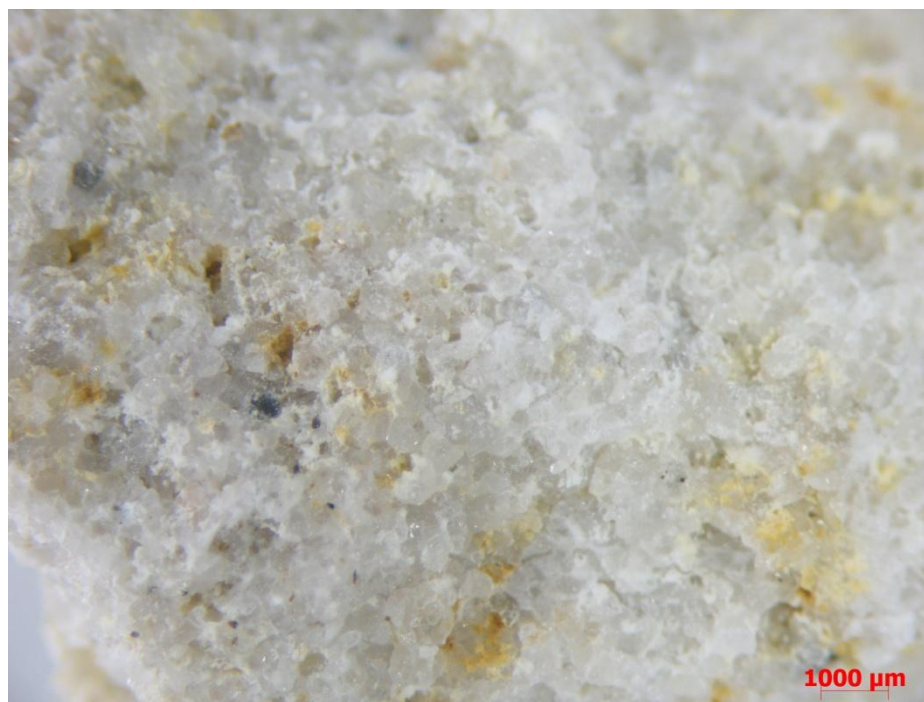
Figura 5.20. Imagem da amostra de rocha arenito, FP-10-30 pós-experimento com água do mar padrão obtida através do MLB.
