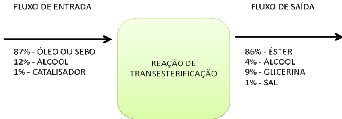
Figura 1.1 - Fluxos mássicos, entradas e saídas de um processo genérico de produção de biodiesel. (Fonte: adaptado de Sebrae, 2007)
