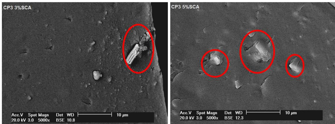
Figura 5.26. Micrografia dos filmes fraturados por criogenia dos compósitos poliméricos de SCCA via NC2.
