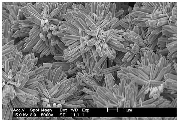
Figura 3.6. Microscopia eletrônica de varredura da carga ZnO em nanovaras (Zhang, 2009).
